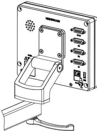
圖形 8: 產品固接在多位置固定架上
