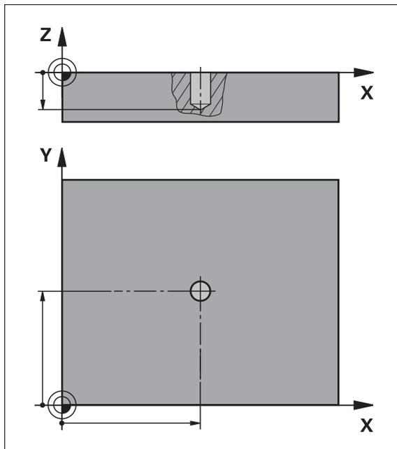
圖形 54: 鑽孔單節的示意圖
