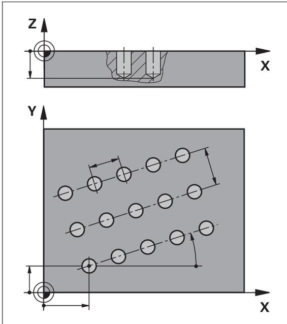
圖形 45: 孔單節列的圖解圖
