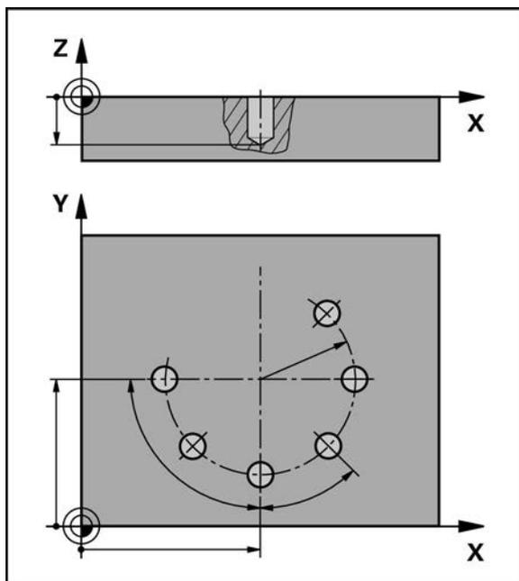
圖形 55: 栓孔圓形單節的圖解圖
