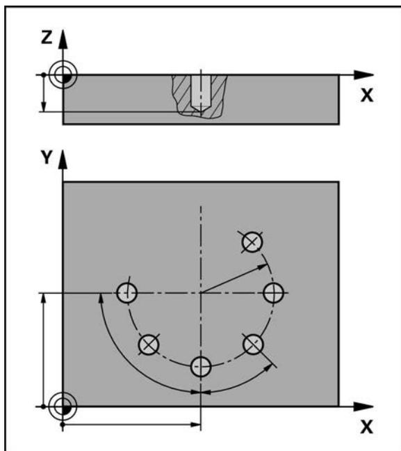
圖形 44: 栓孔圓形單節的圖解圖
