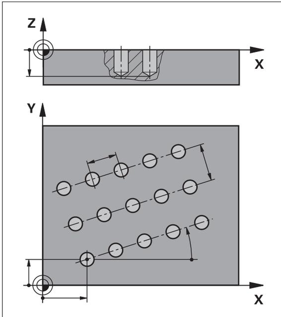
圖形 56: 孔單節列的圖解圖
