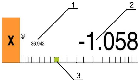
圖形 49: 位置的剩餘距離 畫面含圖形定位輔助
