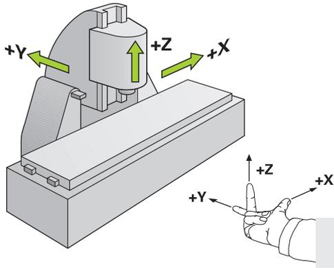
圖形 62: 矩形座標系統指派至工具機軸
