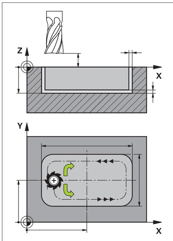
圖形 57: 矩形袋槽單節的圖解圖
