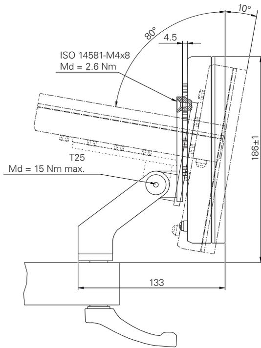
圖形 71: 含多位置固定架的產品尺寸
