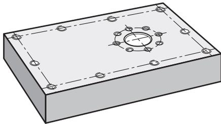
圖形 38: 範例工件-編寫螺栓孔圖以及鑽孔列
