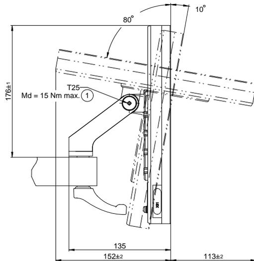
Figura 71: Dimensiones del aparato con soporte Multi-Pos
