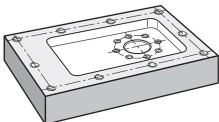
Figura 39: Pieza de ejemplo – Realizar círculo de taladros y fila de taladros
