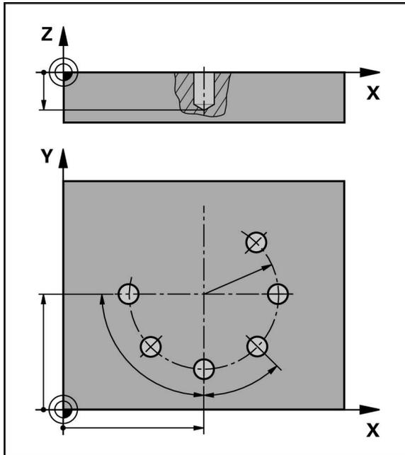
Figura 43: Representación esquemática de la frase Círculo de taladros
