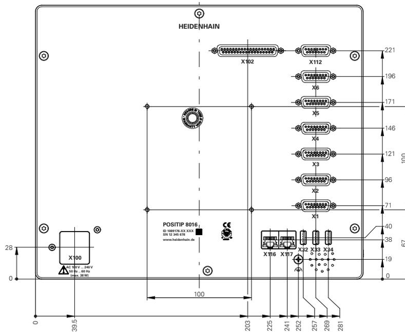
Figura 66: Mediciones de la parte trasera de aparatos con ID 1089176-xx
