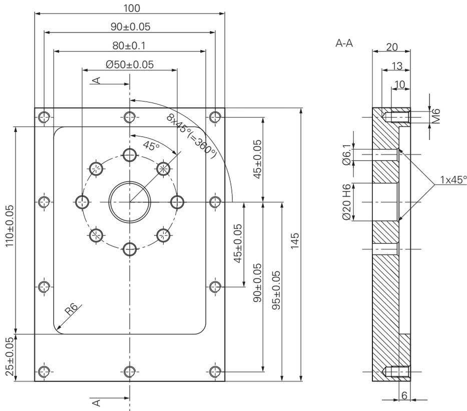
Figura 31: Pieza de ejemplo – Dibujo técnico
