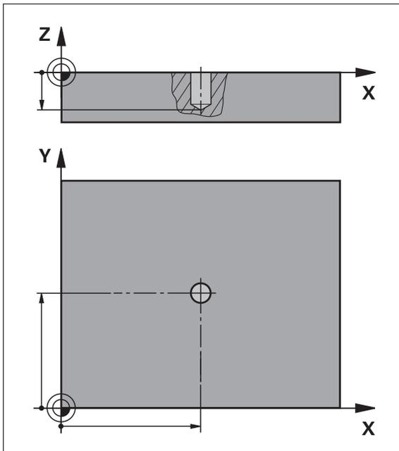
Figura 42: Representación esquemática del bloque **Taladro**
