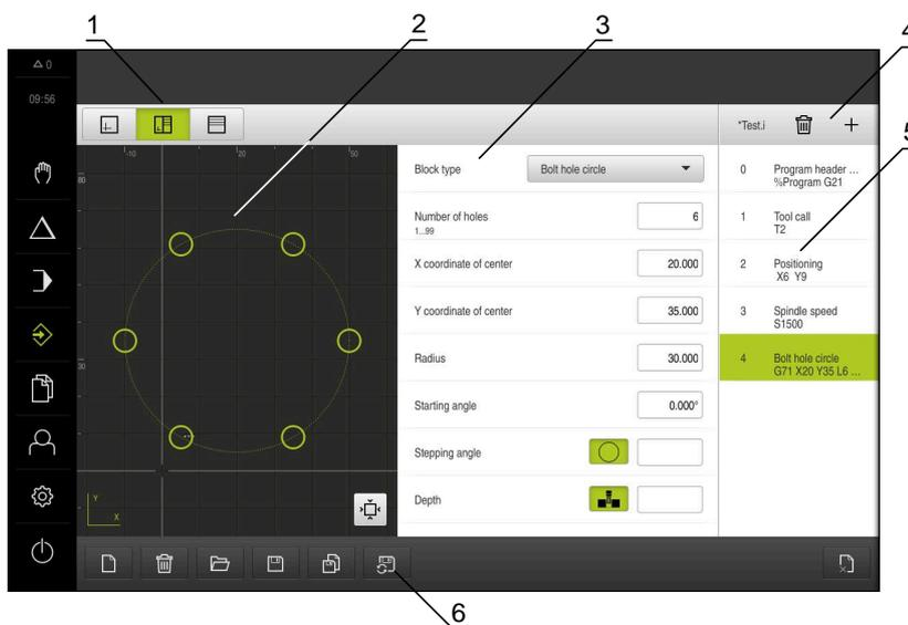
Figura 58: Ejemplo de programa en el modo de funcionamiento **Programación**
