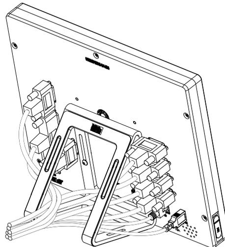
Figura 5: Cableado en soporte bisagra Duo-Pos
