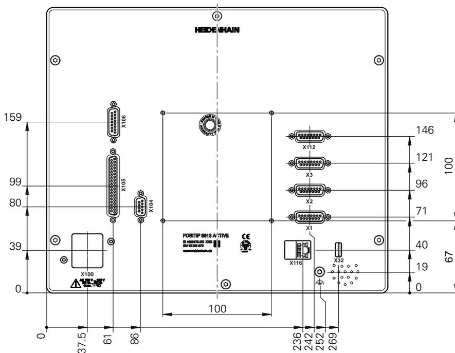
Figura 65: Mediciones de la parte trasera del equipo
