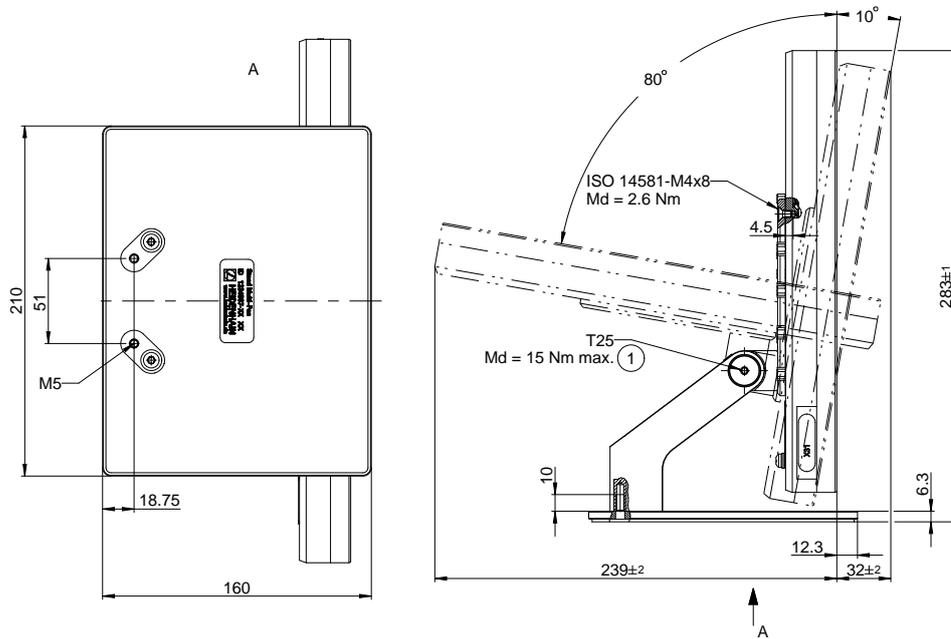
Figura 70: Dimensiones del aparato con pie de soporte Multi-Pos
