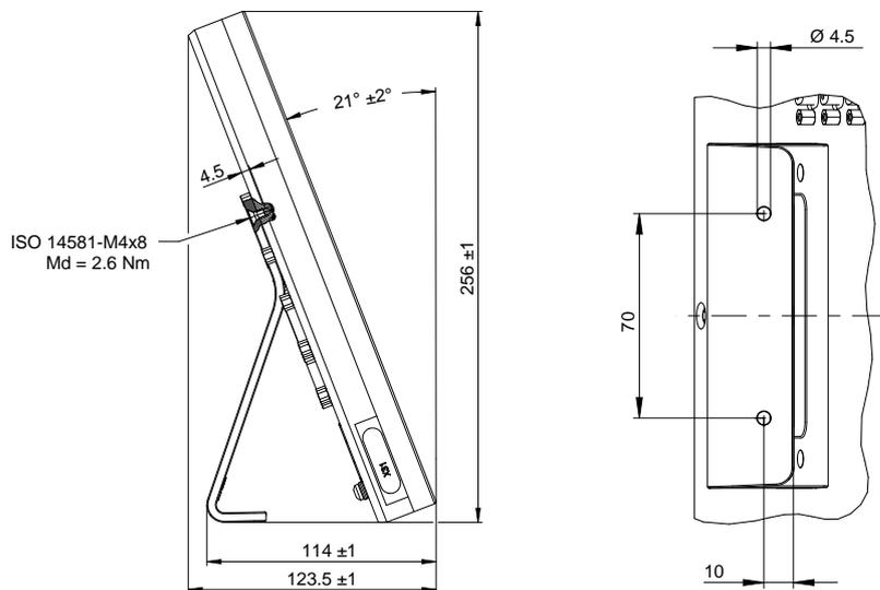
Figura 68: Medidas del equipo en soporte bisagra Single-Pos
