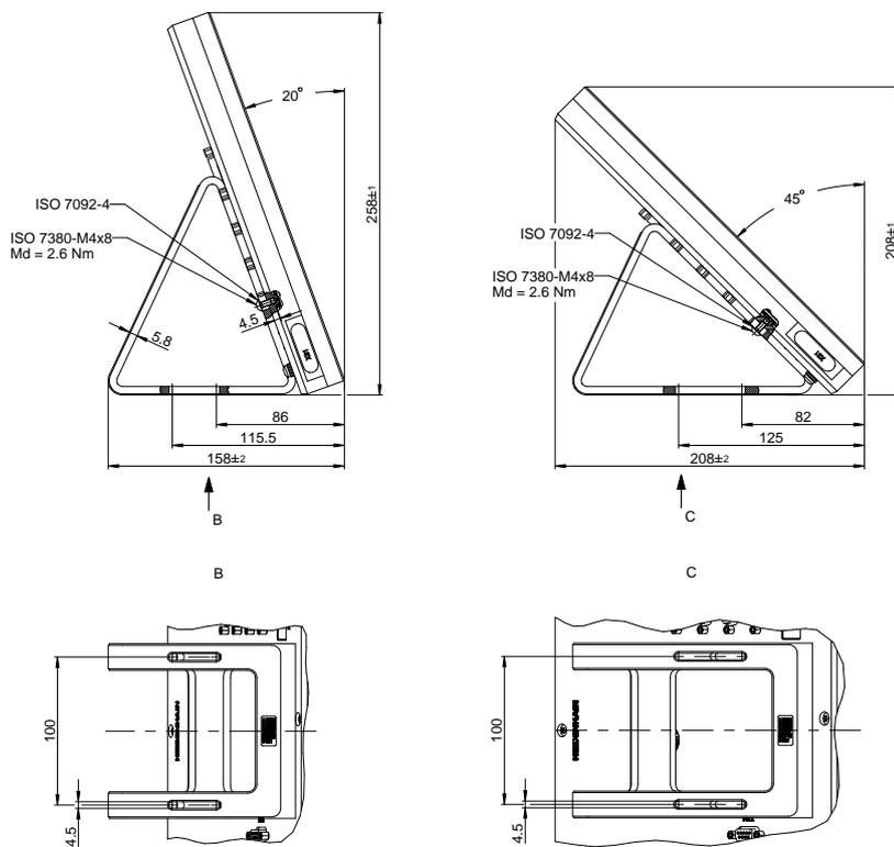
Figura 69: Dimensiones del aparato con pie de soporte Duo-Pos
