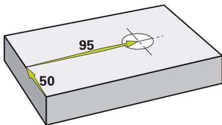
Figura 33: Pieza de ejemplo – Realizar orificio pasante
