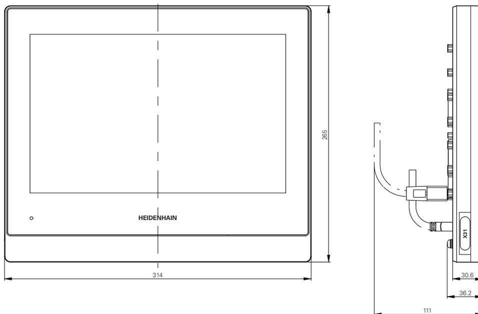
Figura 64: Mediciones de la carcasa
