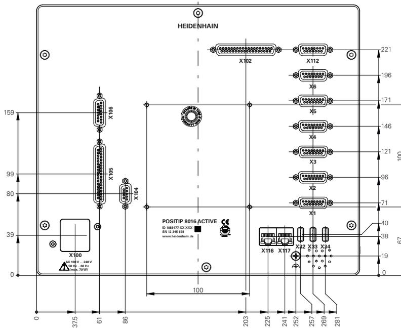
Figura 67: Mediciones de la parte trasera de aparatos con ID 1089177-xx
