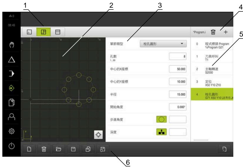
圖形 10: 已經開啟模擬視窗的程式編輯功能表
