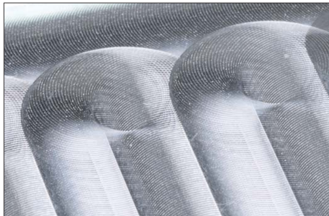
Figure 7 : Usinage sans fonction CTC
