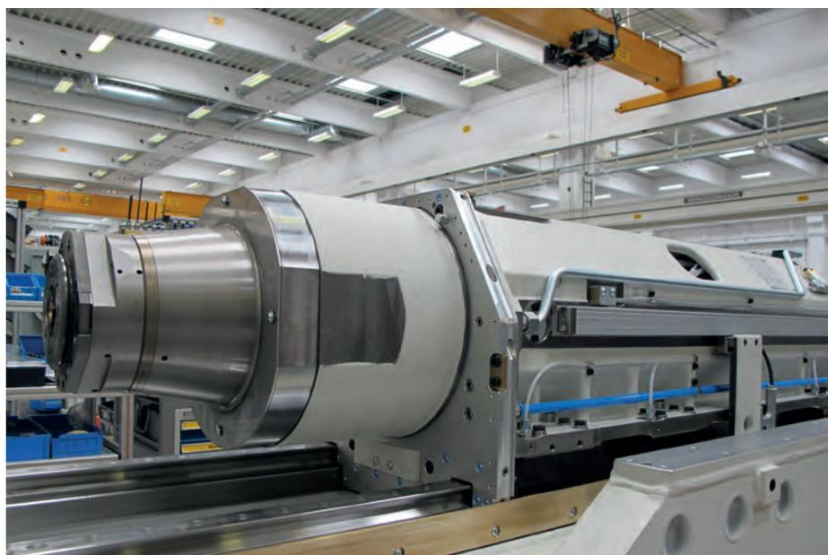
図 5: ハイデンハインのリニアエンコーダを搭載した横形マシニングセンター (写真提供: GROB-WERKE GmbH & Co. KG)
