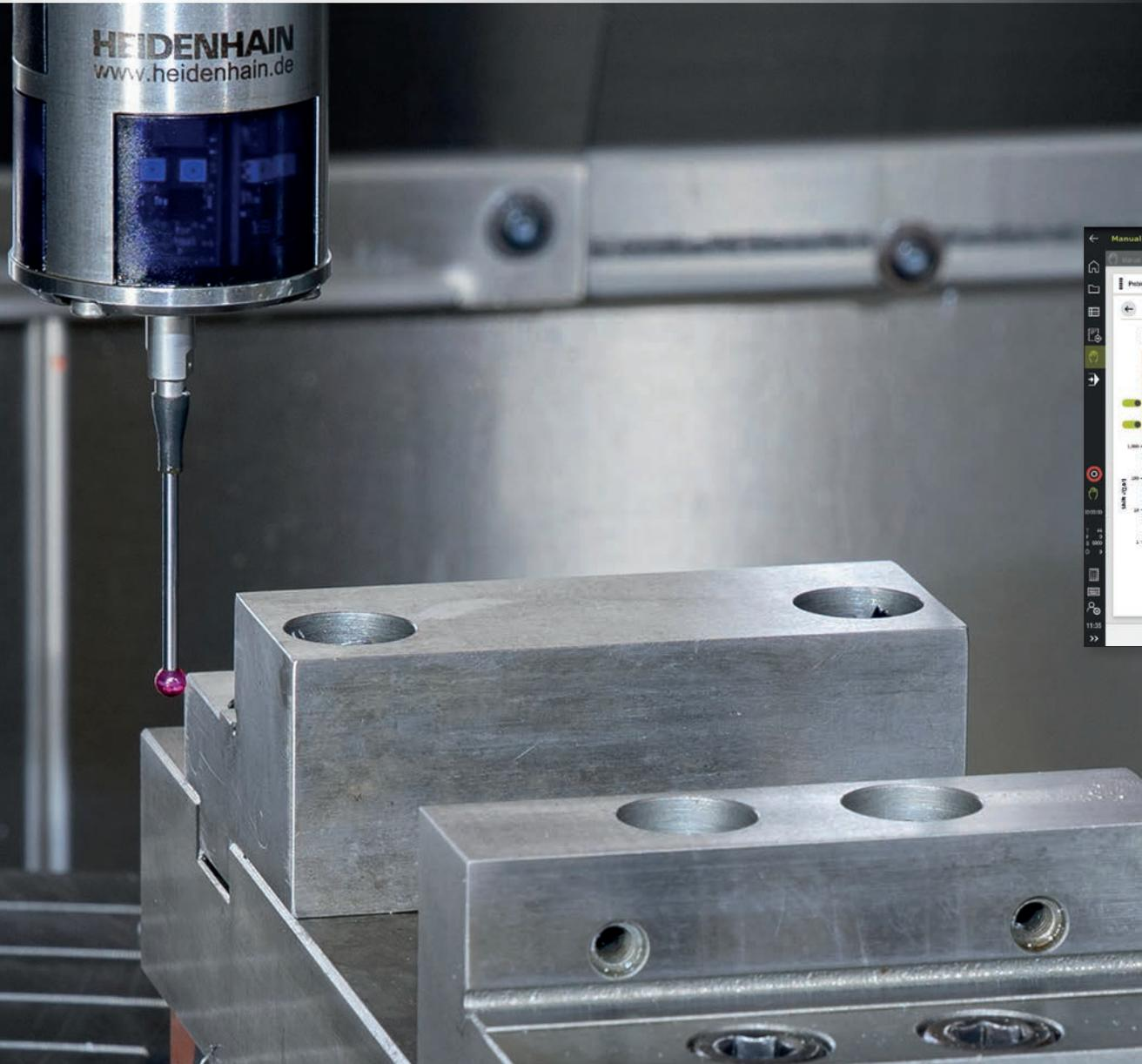
Mit der TNC7 wird DCM (Dynamic Collision Monitoring) in die nächste Generation überführt. DCM schützt nicht nur vor Kollisionen zwischen Maschinenteilen und Werkzeugen. Auch Spannmittel können in 3D-Formaten importiert, überwacht und mit einem neuen Zyklus einfach grafisch unterstützt eingemessen werden.
