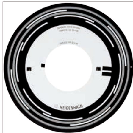
带条块换向轨的圆光栅码盘
