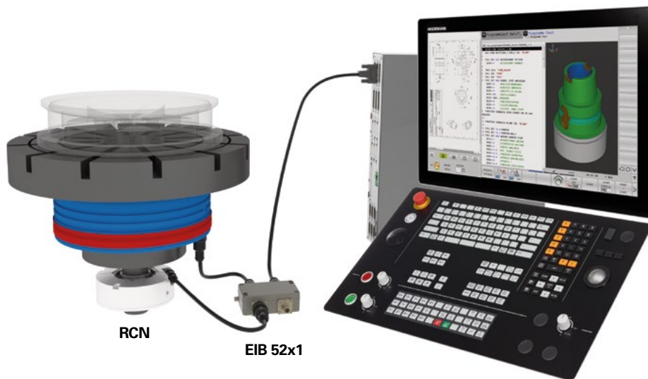
EIB 5211とRCN 5311を用いたDDモータの温度を現場でデータ処理の例
