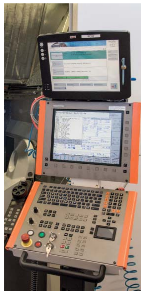
iTNC 530与车间管理系统直接连接，自动记录机床数据。
