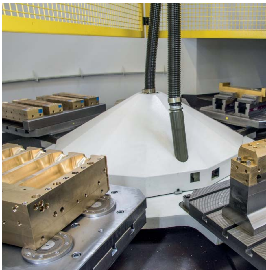
GF加工方案集团的托盘系统结构紧凑且易于使用。
