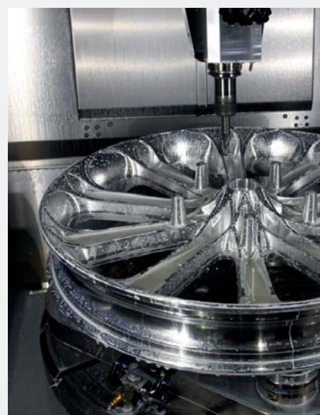
3-D铣削的Unbreakable车轮的毛坯是一块单体铝锭。
