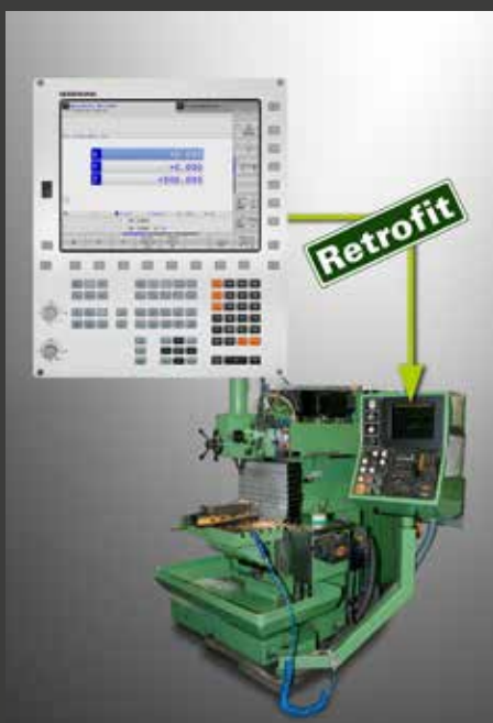
持续升级机床，提高机床加工效率和精度：用现代化的海德汉数控系统取代经典的TNC 150、TNC 151和TNC 155数控系统
