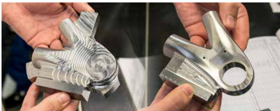
两步就能得到完美工件： 粗加工（左）和精加工（右）后的悬挂系统接头。
