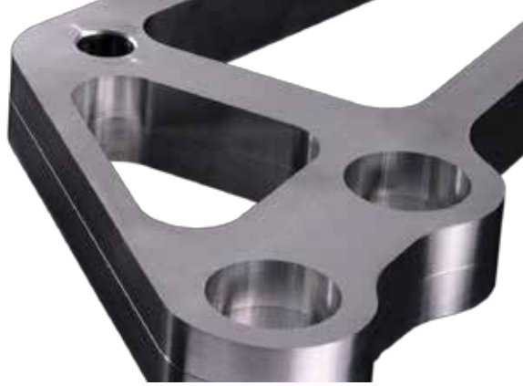
第二次加工后清晰可见： 由于滚珠丝杠驱动的热膨胀造成70 µm偏差
