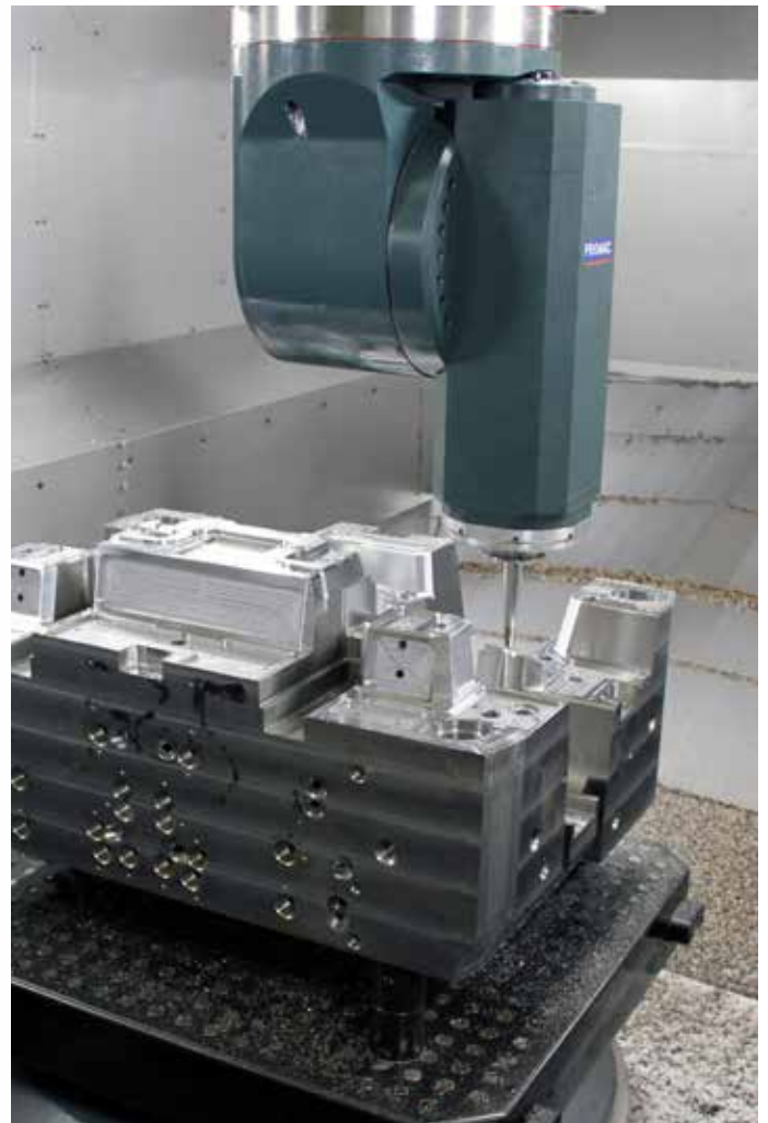
可塑性: 机床铣头交换系统可实现用一台机床完成所有加工任务。
