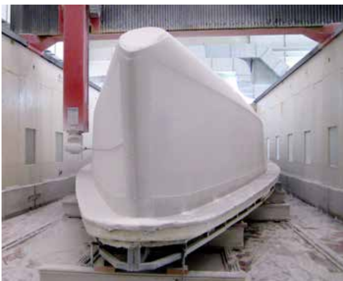
Belotti加工中心加工20.37 m长船体，公差仅1 mm。
