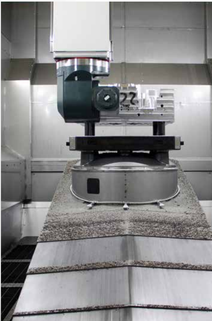
灵活性: 摆动工作台可进行5轴和5面的钻孔及铣削加工。
