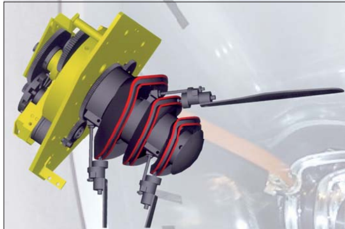
3-D-Steuerscheibe mit Zeigerdreh- und Schwenktechnik
