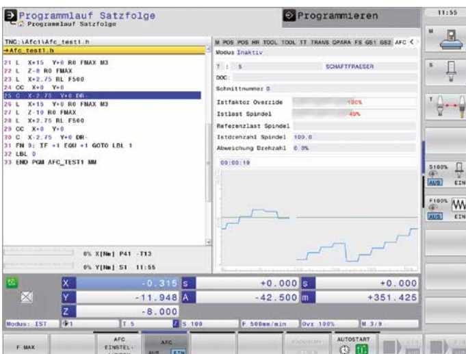
Das Liniendiagramm zeigt die aktuelle Spindelleistung und die angepasste Vorschubgeschwindigkeit mit der Funktion AFC.
