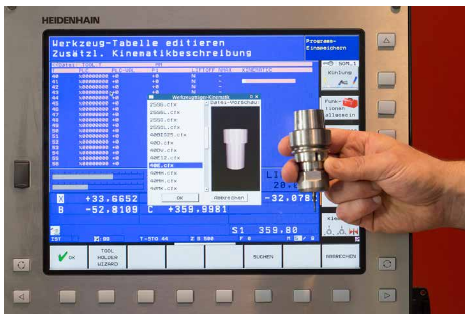
Eine umfassende Lösung: Die Kollisionsüberwachung DCM berücksichtigt neben den maschinenfesten Komponenten sowohl Werkzeuge wie auch Werkzeugträger, ...
