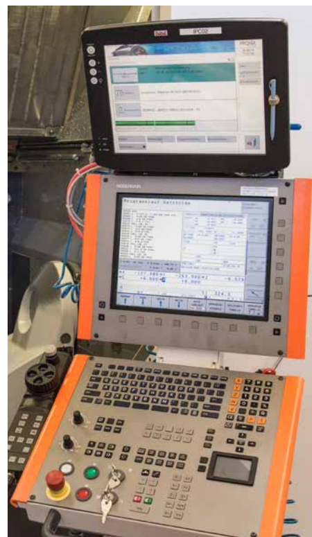
Zur automatischen Maschinendaten-Erfassung sind iTNC 530 und Shop-Floor-Management direkt miteinander verknüpft.
