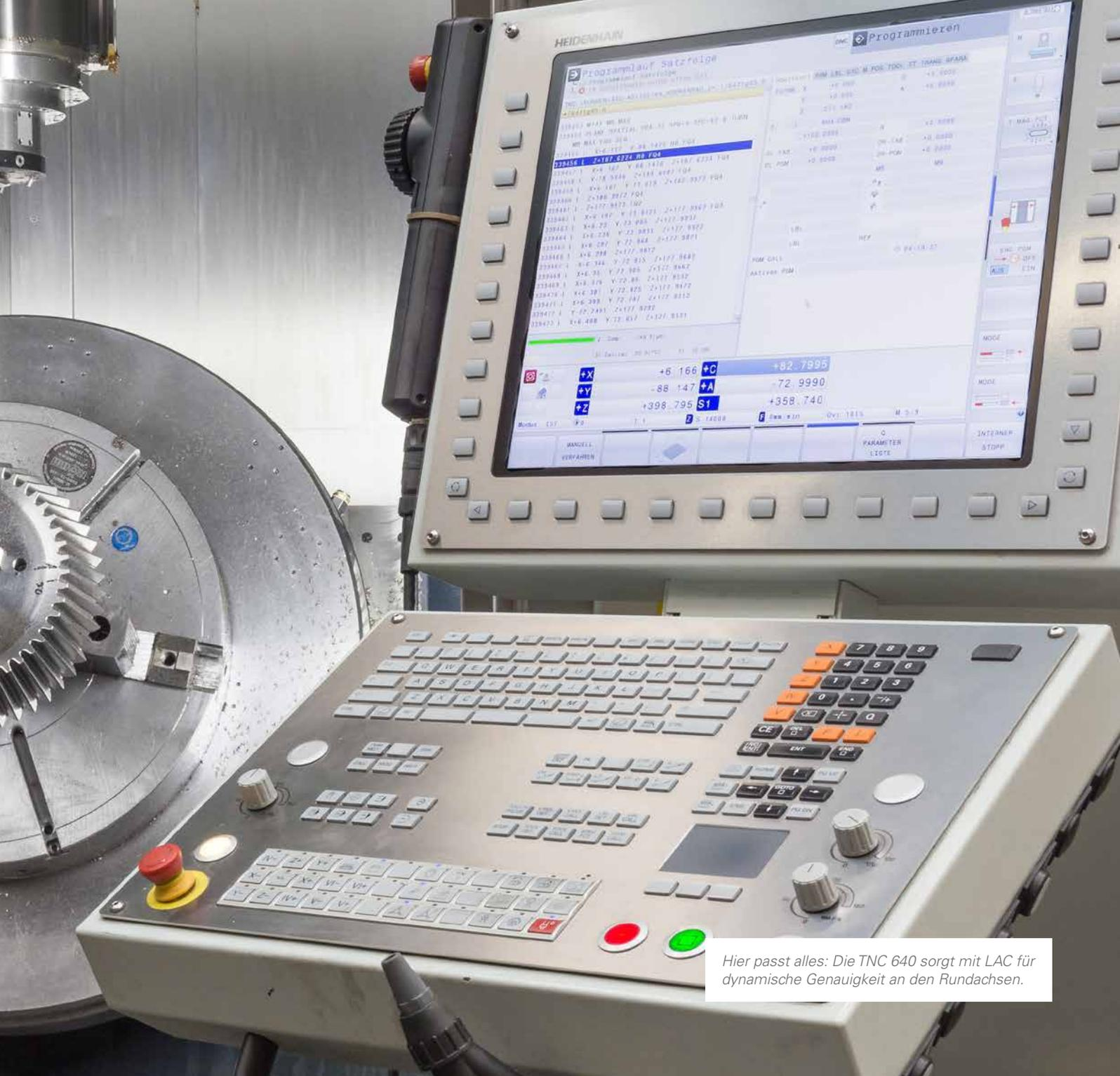
Hier passt alles: Die TNC 640 sorgt mit LAC für dynamische Genauigkeit an den Rundachsen.
