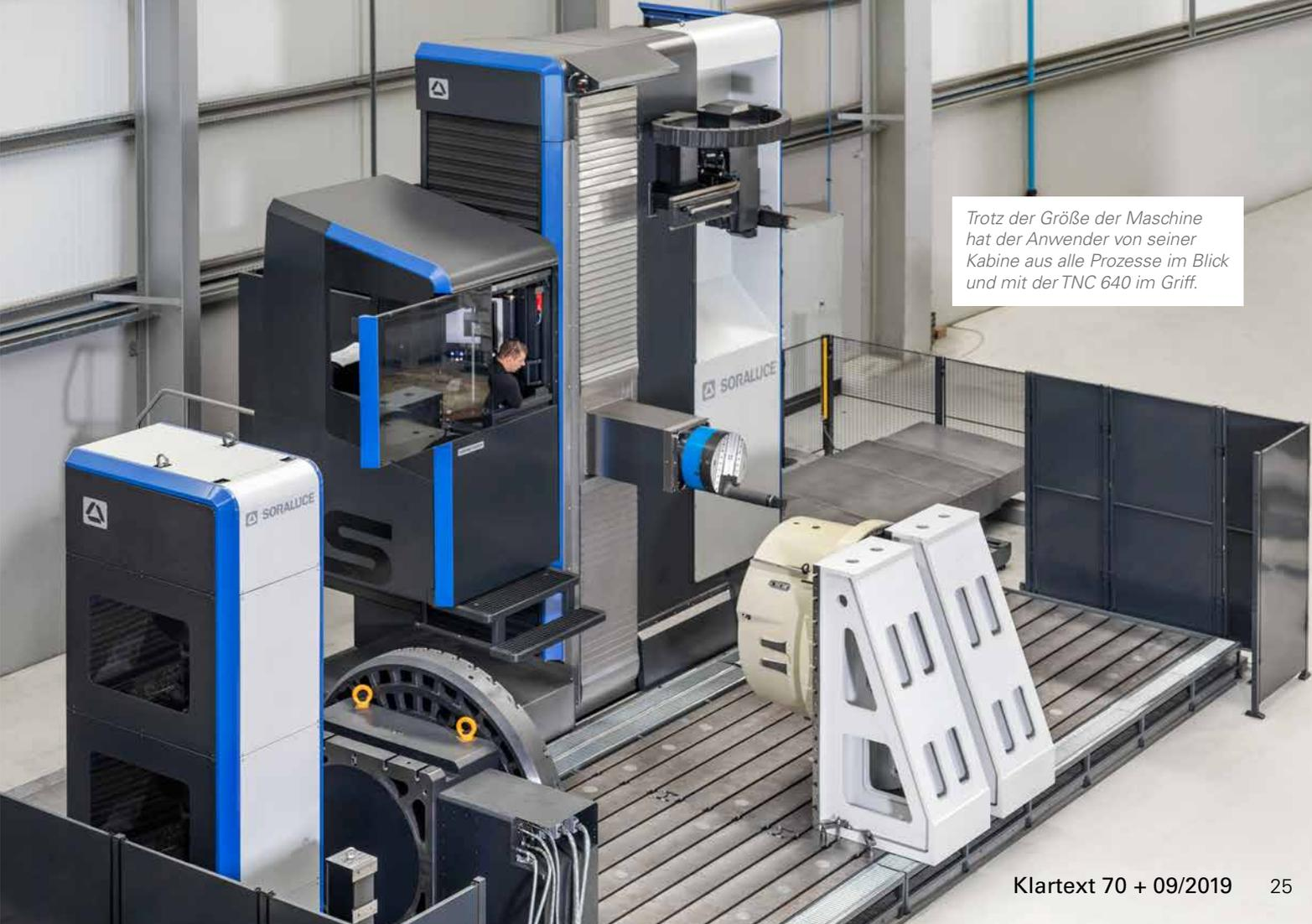
*Trotz der Größe der Maschine hat der Anwender von seiner Kabine aus alle Prozesse im Blick und mit der TNC 640 im Griff.*
