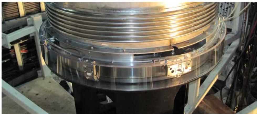
Anbau der ERA 8400-Winkelmessgeräte am Teleskop-Antrieb für die Azimuth-Positionierung
