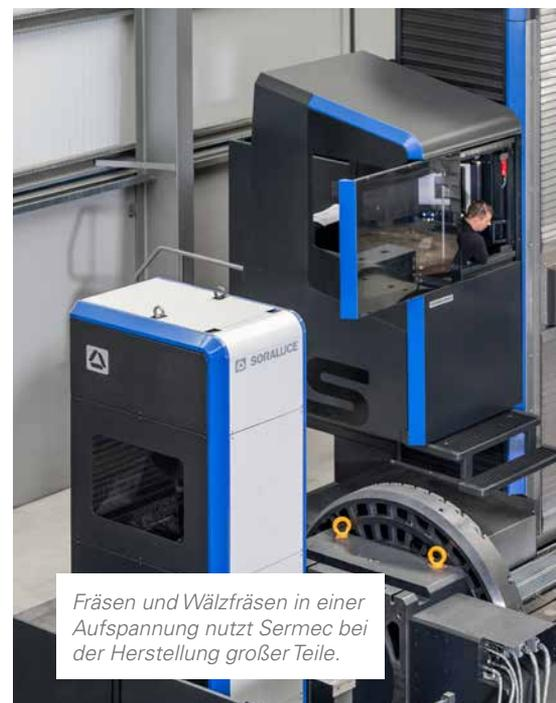
*Fräsen und Wälzfräsen in einer Aufspannung nutzt Sermec bei der Herstellung großer Teile.*
