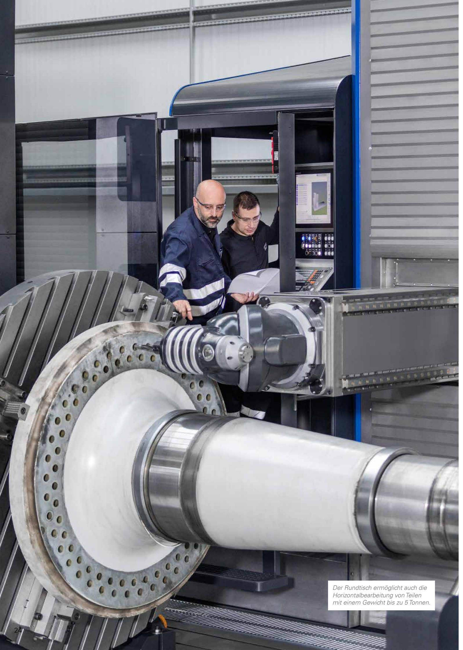
*Der Rundtisch ermöglicht auch die Horizontalbearbeitung von Teilen mit einem Gewicht bis zu 5 Tonnen.*
