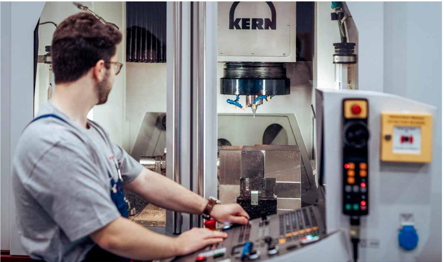
*Dank HEIDENHAIN-Steuerung iTNC 530 und Klartext-Programmierung kann NH Watches seine Teile sogar genauer als notwendig fertigen.*
