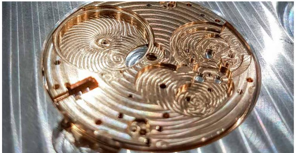
*Hochpräzise Kleinstteile wie diese Platine sorgen dafür, dass die Uhren von NH Watches lebenslang richtig ticken.*
