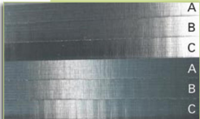
Qualität einer gefrästen Werkstückoberfläche, die mit unterschiedlichen Signalqualitäten hergestellt wurden
