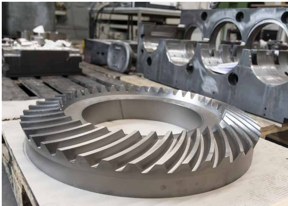
El mecanizado en 5 ejes posibilita casi cualquier geometría de rueda dentada.
