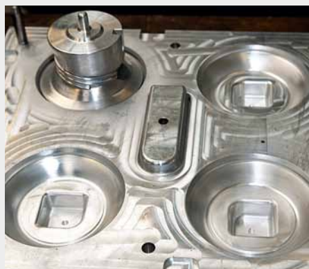
Moldes con contornos complejos; gracias al TNC 620, se simplifica el mecanizado.
