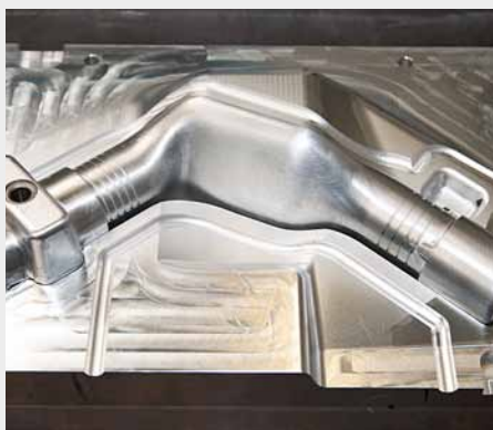
Moldes con contornos complejos; gracias al TNC 620, se simplifica el mecanizado.
