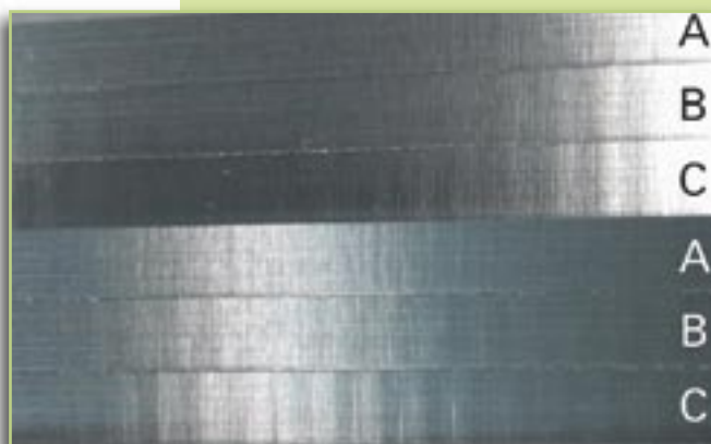
Calidad de la superficie de una pieza fresada fabricada con calidades de señal diferentes
