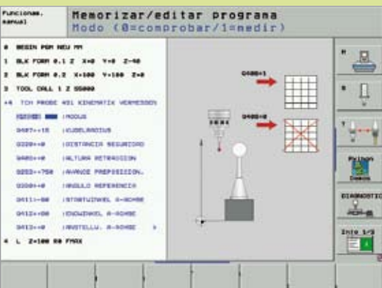
Nueva función KinematicsOpt: medición automática de la cinemática y recalibración automática de la cinemática de la máquina
