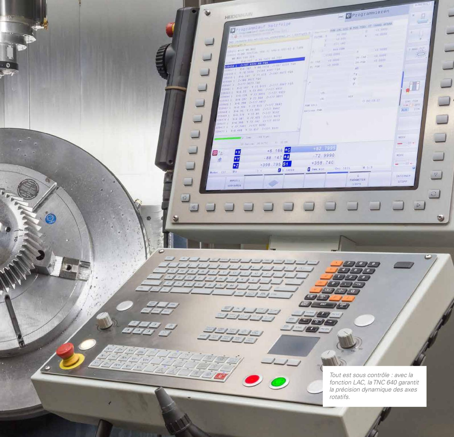
Tout est sous contrôle : avec la fonction LAC, la TNC 640 garantit la précision dynamique des axes rotatifs.
