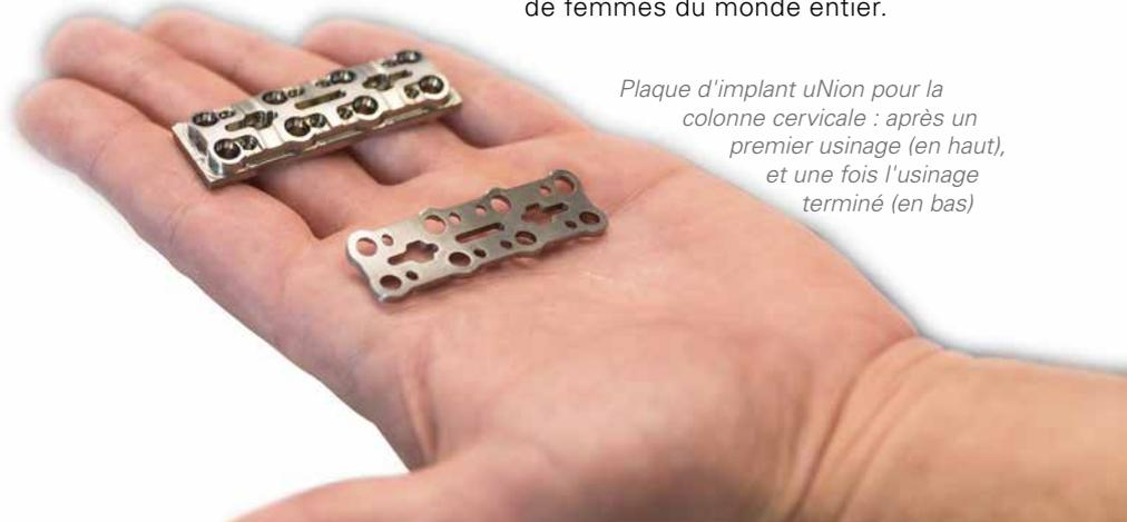
Plaque d'implant uNion pour la colonne cervicale : après un premier usinage (en haut), et une fois l'usinage terminé (en bas)
