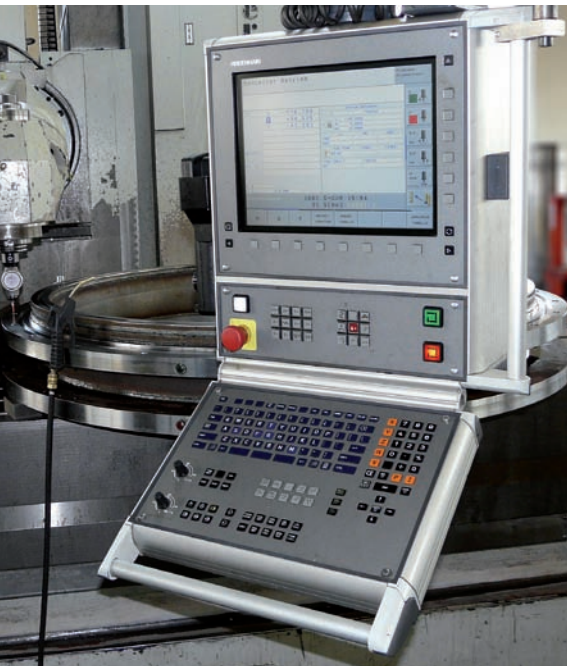
Usinage d'un arbre de turbine de 8 tonnes sur une fraiseuse latérale Zayer commandée par l'iTNC 530
