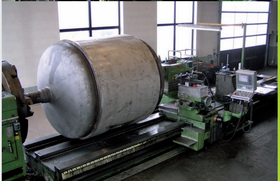
Tournage à la volée (ci-dessus) Usinage d'un tambour mélangeur de 2,1 m de diamètre (ci-dessous)
