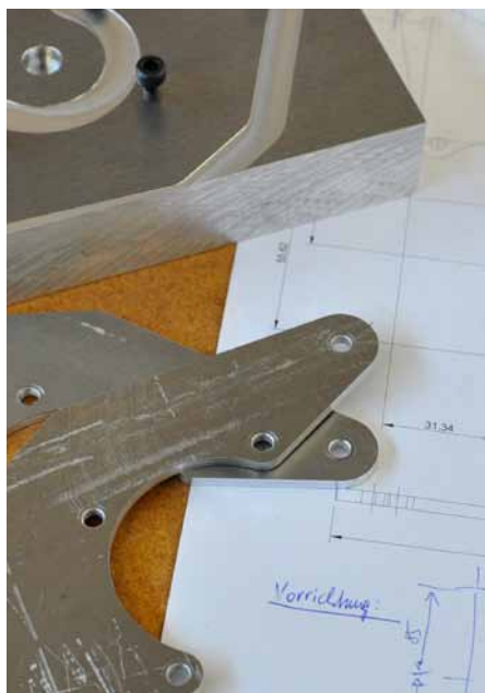
Une production efficace grâce à des solutions simples : la création de motifs de perçage avec le convertisseur DXF et le tableau de points d'origine.
