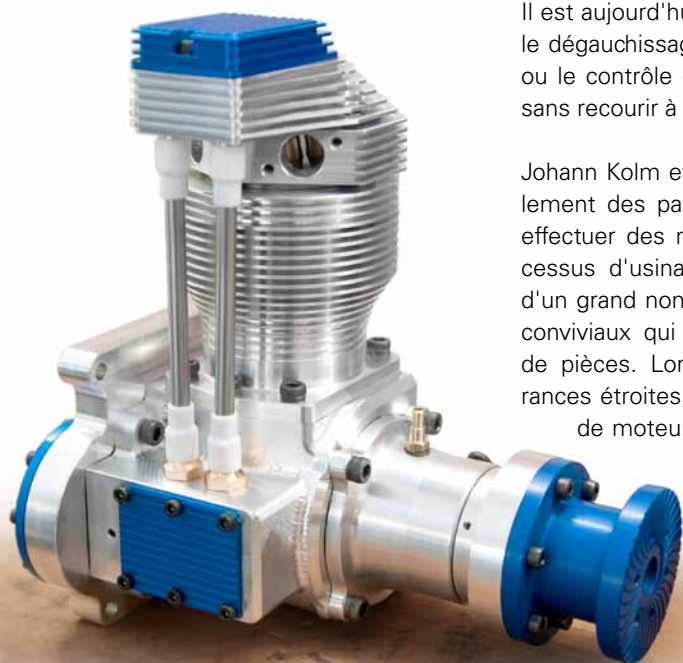
Une précision optimale avec des petites dimensions : les composants des moteurs sont produits de manière particulièrement optimale grâce à la TNC 620.
