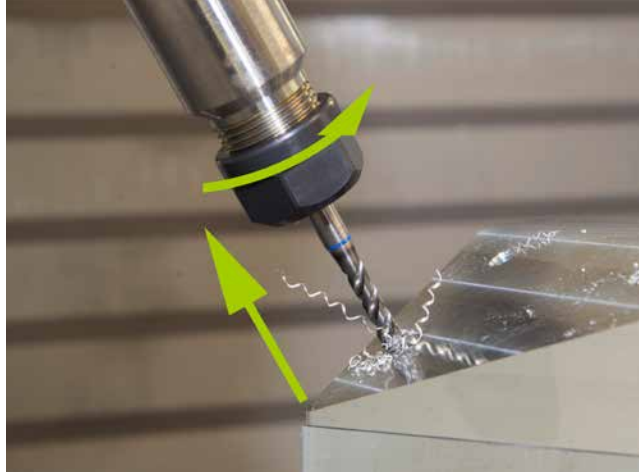
Dégagement d'outil d'un filet assisté par la TNC
