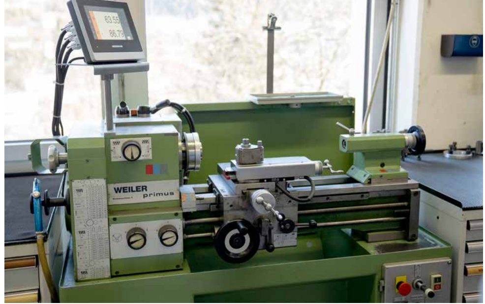
Au total, huit machines manuelles conventionnelles ont été rééquipées dans le cadre du rétrofit.
