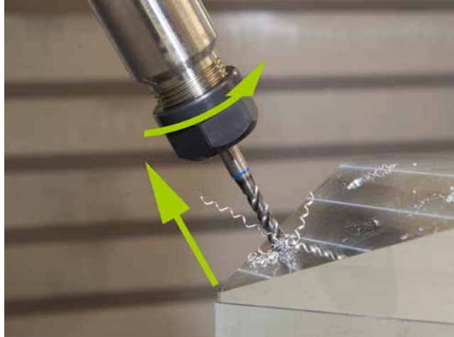
Uscita assistita da un foro filettato
