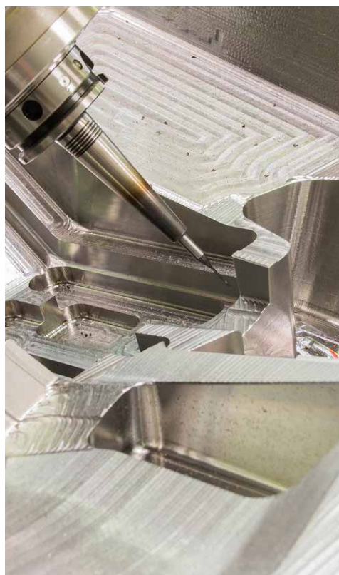
L'azienda Müller Modell- und Formenbau realizza con iTNC 530 stampi complessi per l'iniezione di parti per autoveicoli in materiale plastico, a pagina 12
