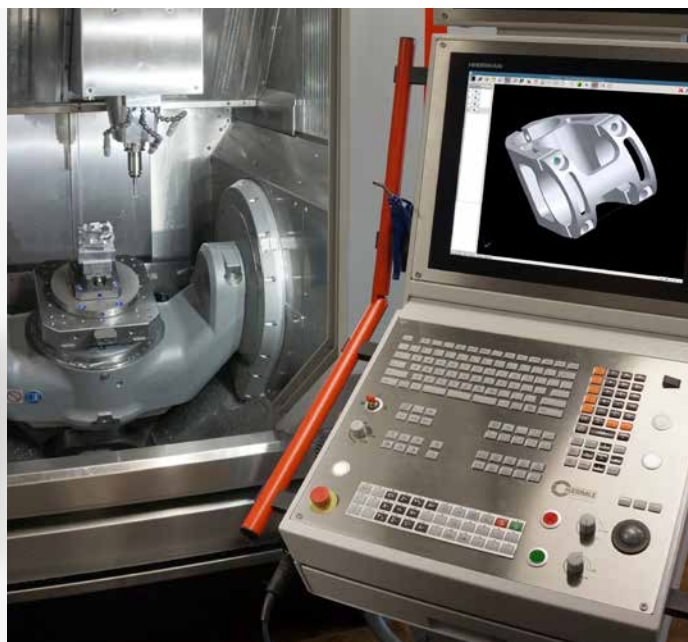
Dati 3D di un componente complesso, ad esempio questo supporto del manubrio di una mountain bike, possono essere importati direttamente nel programma NC.
