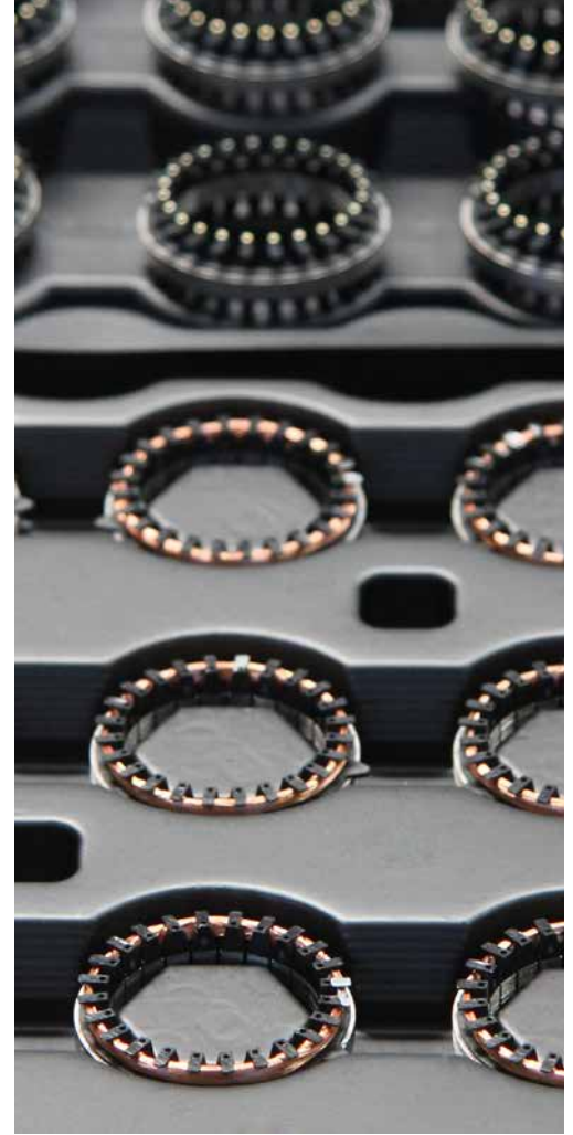
Prima e dopo: davanti i nuclei degli statori finiti e dietro quelli ancora vuoti
