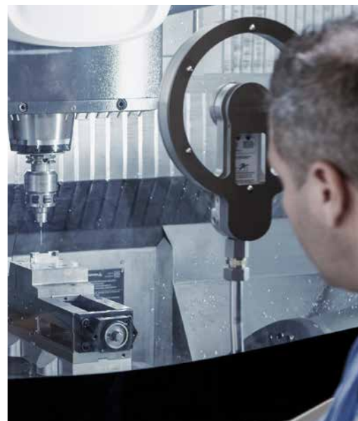
Tra i punti di forza dei controlli numerici TNC, per C.N. Meccanica sono da evidenziare i cicli di tastatura per la misura diretta del pezzo in macchina
