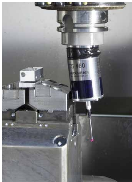
Tra i punti di forza dei controlli numerici TNC, per C.N. Meccanica sono da evidenziare i cicli di tastatura per la misura diretta del pezzo in macchina
