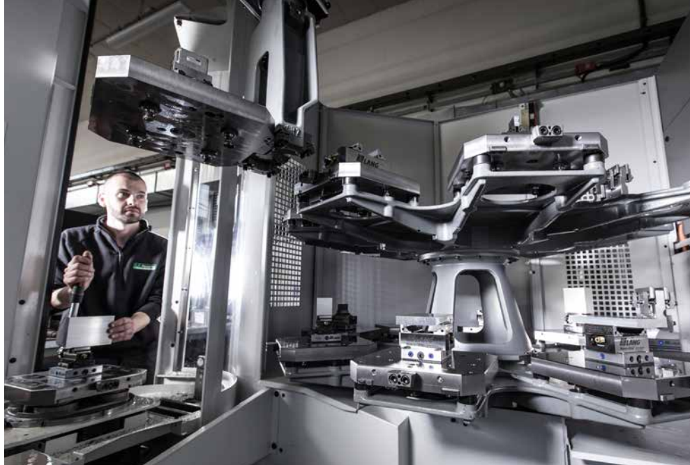
Le lavorazioni sono realizzate tramite fresatura, principalmente su macchine a 5 assi, alcune delle quali pallettizzate per assicurare la massima flessibilità e continuità alla produzione
