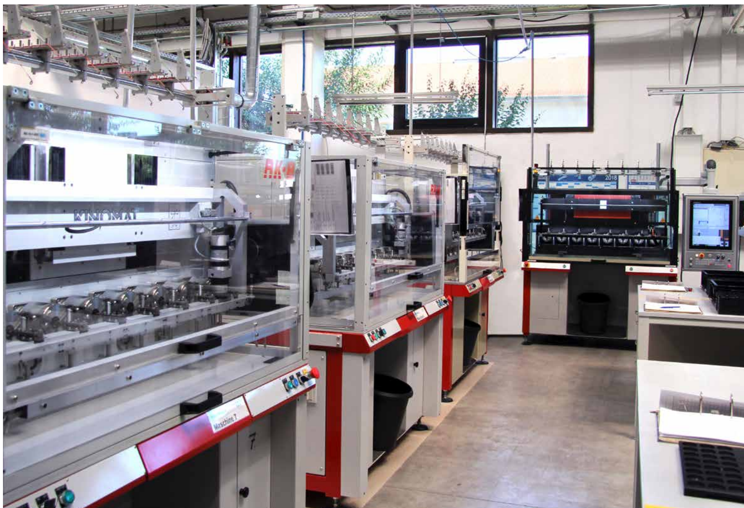
In testa è collocata l'avvolgitrice per resolver convertita ed equipaggiata con il controllo numerico TNC 620, a sinistra tre dei sei impianti che dovranno essere convertiti entro la fine del 2019.
