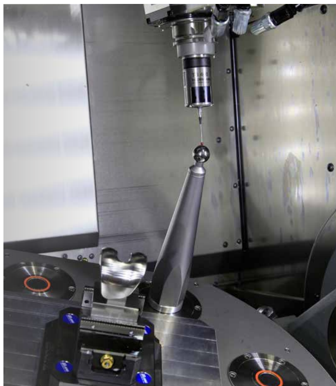
La funzione TNC KinematicsOpt misura con semplicità e rapidità gli assi rotativi e orientabili servendosi di una sfera di calibrazione. Gli errori possibili vengono compensati con una tabella cinematica e, a seconda delle richieste del cliente, anche protocollati.
