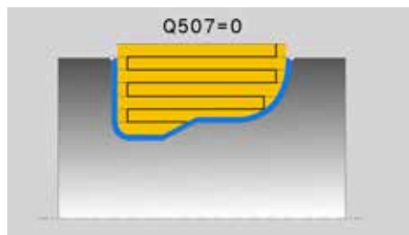
Il ciclo Troncatura-tornitura riduce la lavorazione.
