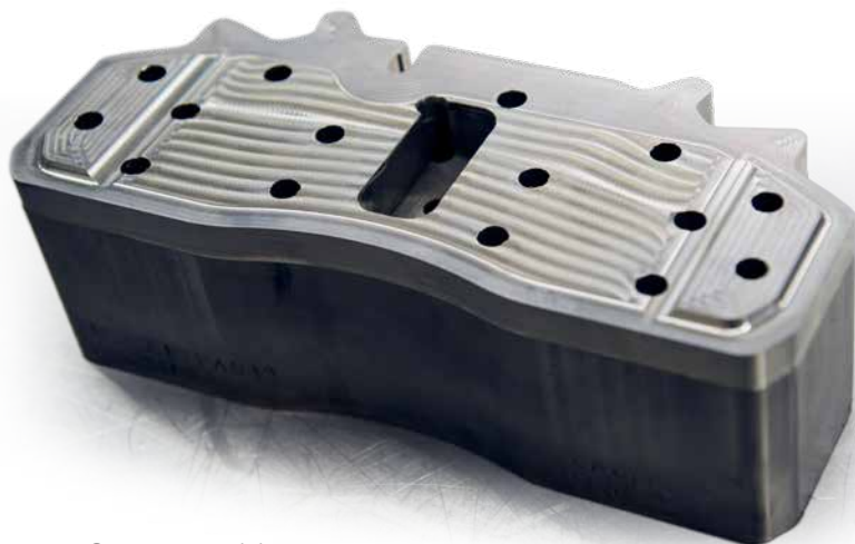
Componente tipico: lo stampo per la punzonatura di una piastra di supporto per il ceppo freni di autocarri...
