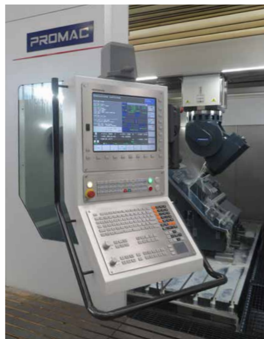
Sharav GVT 2.5, come tutte le macchine realizzate Promac, integra un controllo numerico TNC HEIDENHAIN.
