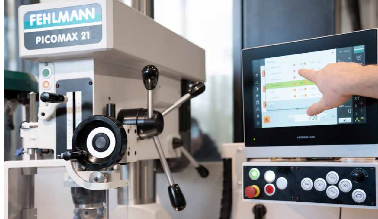
Macchina manuale con tavola motorizzata e POSITIP 8000 ACTIVE: così la FEHLMANN PICOMAX 21-M sostituisce semplici macchine CNC.
