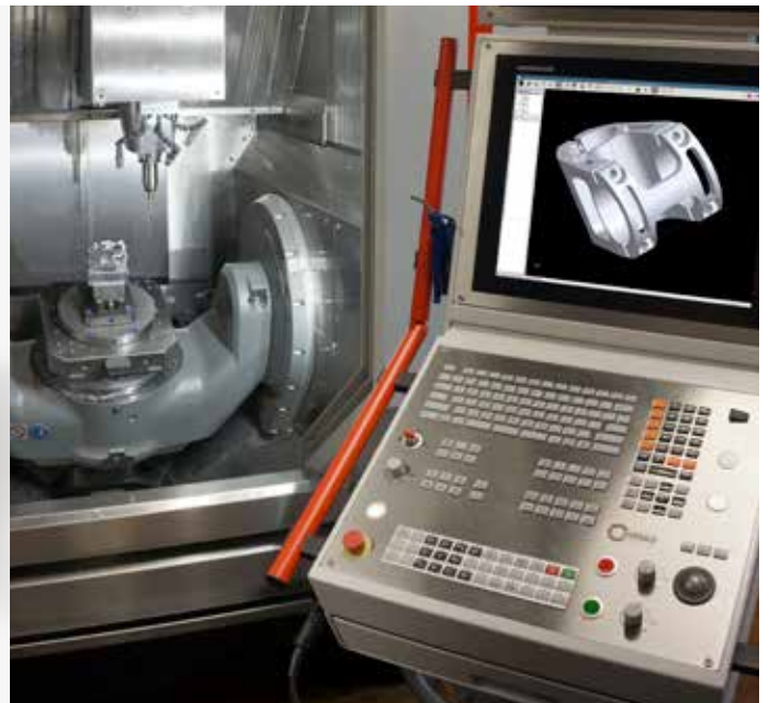
예를 들어 산악 자전거용 페달처럼 복잡한 구성품의 3-D 데이터를 NC 프로그램에 직접 불러올 수 있습니다.
