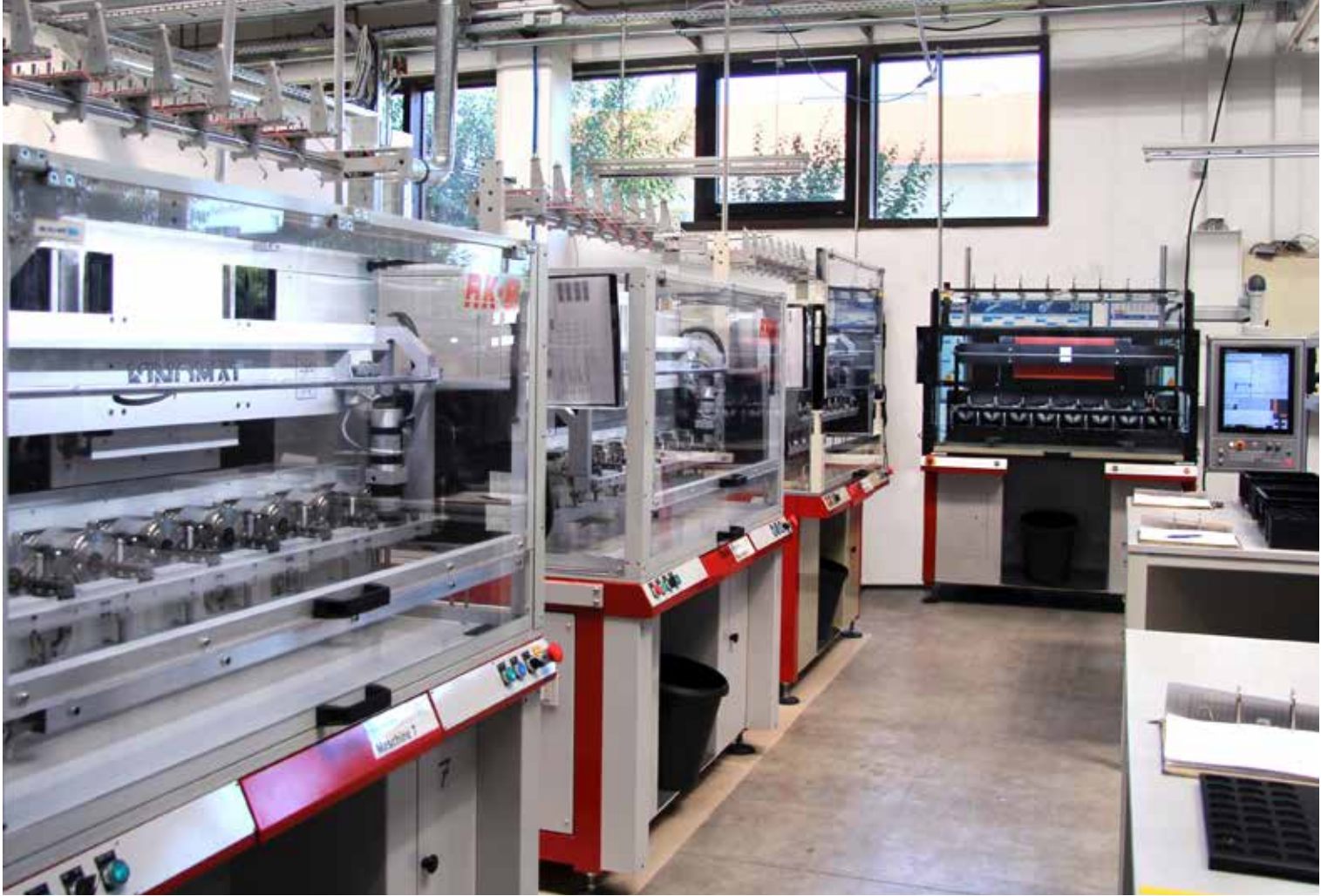
TNC 620 컨트롤러로 업그레이드된 레졸버 와인딩 머신은 헤드 끝에 위치하며 왼쪽의 6개 시스템 중 3개는 2019년 말까지 업그레이드가 완료 될 예정입니다.
