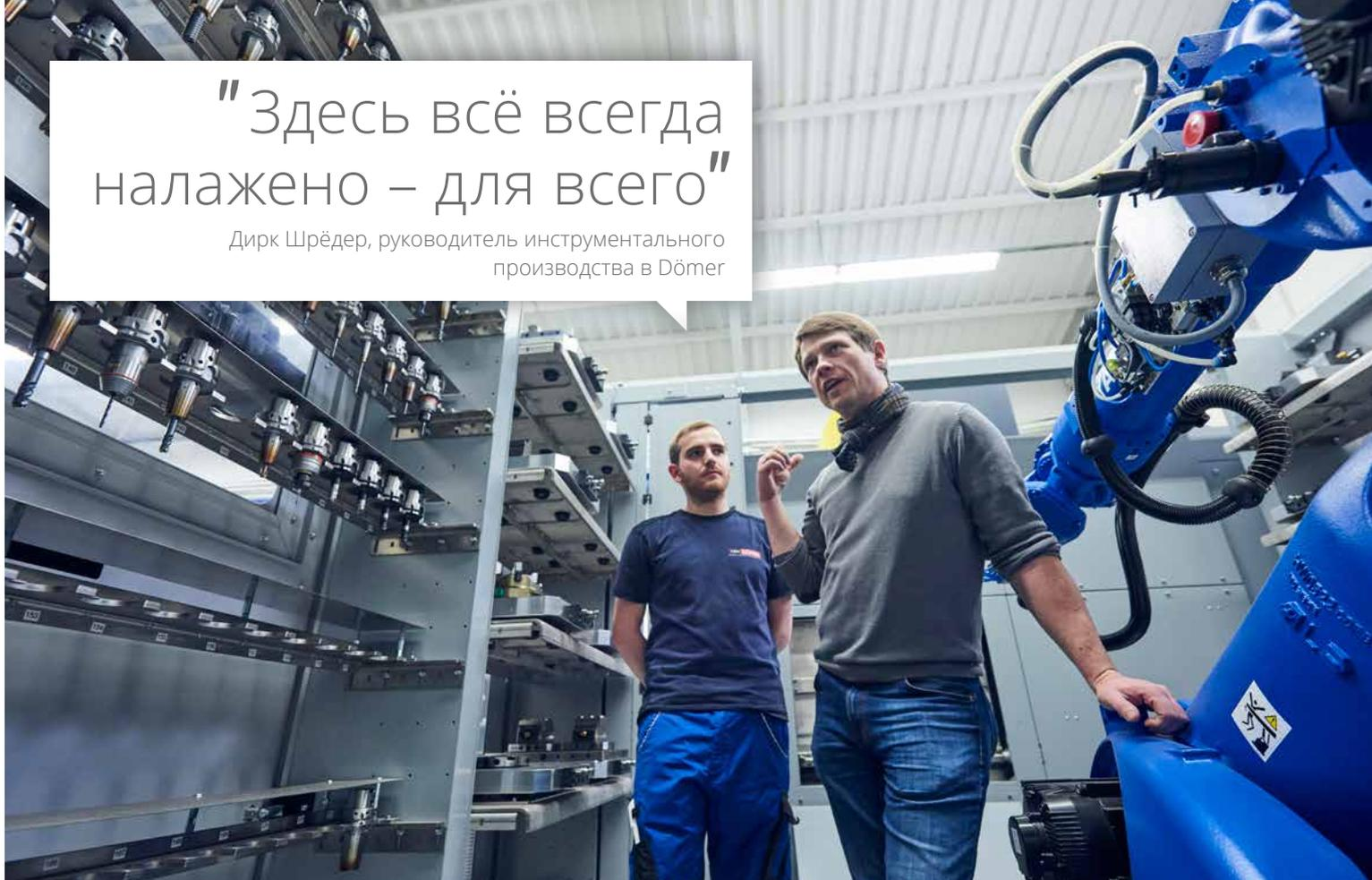
Филлип Шрёдер (слева) и Дирк Шрёдер внутри роботизированной ячейки с комбинированной системой замены палет и инструмента
