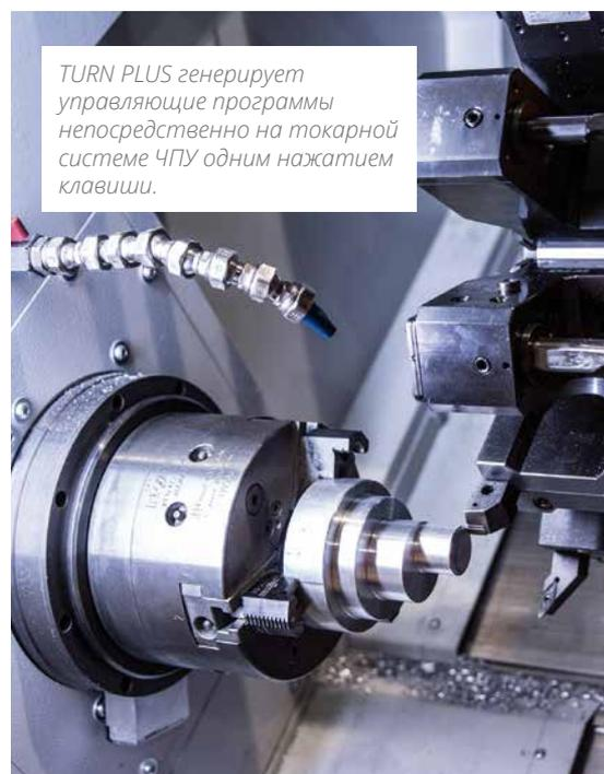
*TURN PLUS генерирует управляющие программы непосредственно на токарной системе ЧПУ одним нажатием клавиши.*
