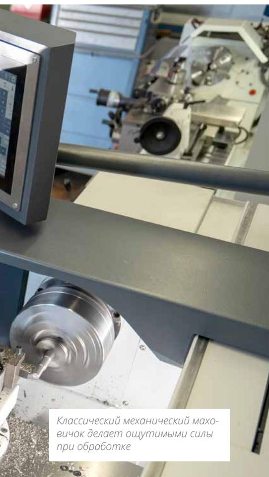
*Классический механический маховичок делает ощутимыми силы при обработке*
