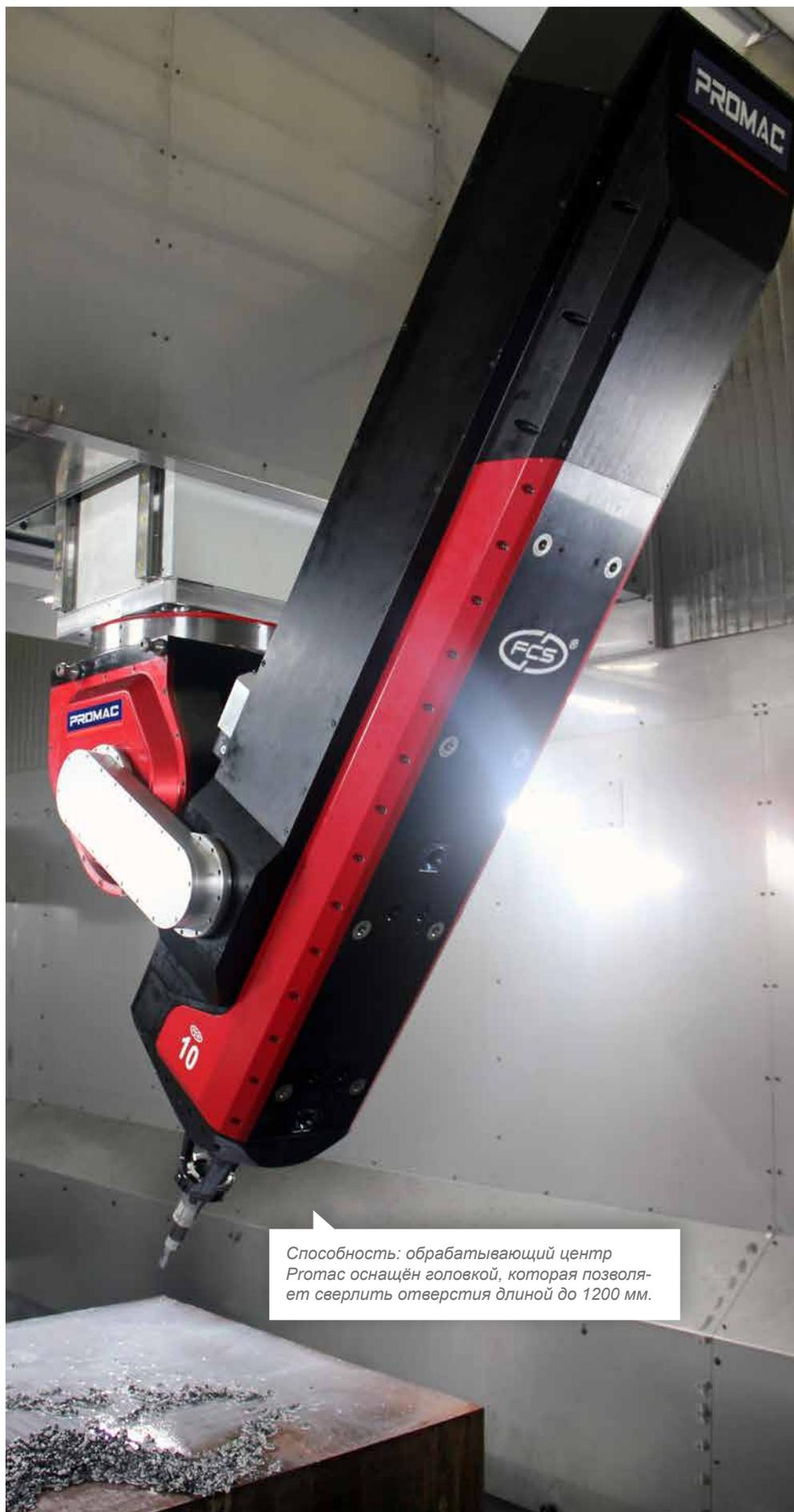
*Способность: обрабатывающий центр Promac оснащён головкой, которая позволяет сверлить отверстия длиной до 1200 мм.*
