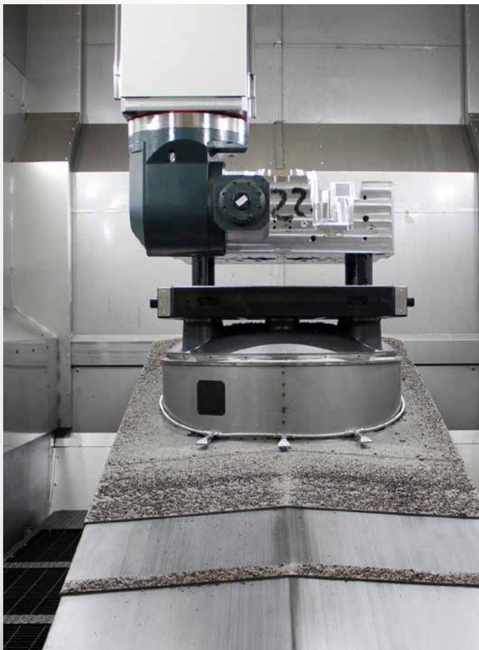
Гибкость: наклонный стол позволяет сверлить и фрезеровать по пяти осям и на пяти поверхностях.
