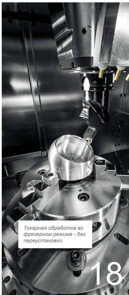
Токарная обработка во фрезерном режиме - без переустановки.
