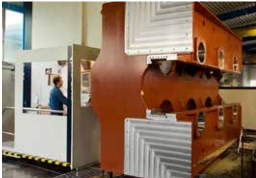
調整鑽油機高度的特殊零件—搭配水電業及飛機與造船工業的組件—HELDECO所製造優異零件的範例。
