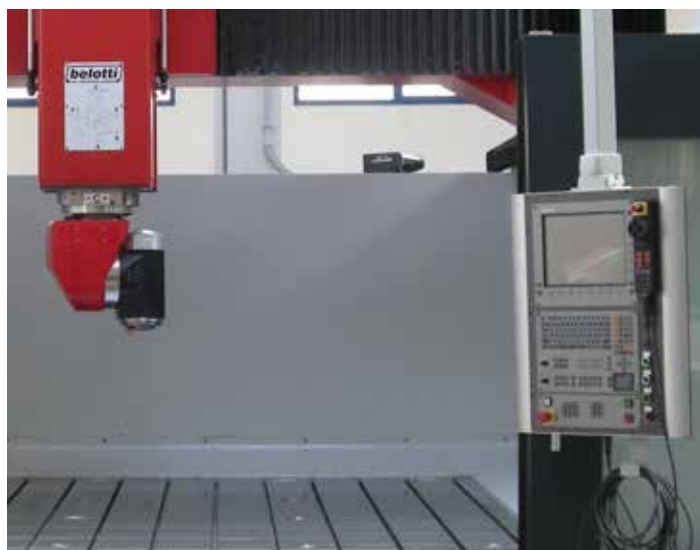
Persico Marine的願望明確表示：Belotti加工中心機由HEIDENHAIN iTNC 530控制。
