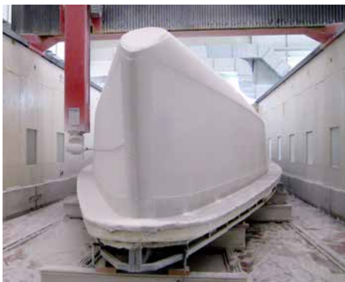
由Belotti加工中心機所建造長度20.37公尺，而公差只有1毫米的船身。
