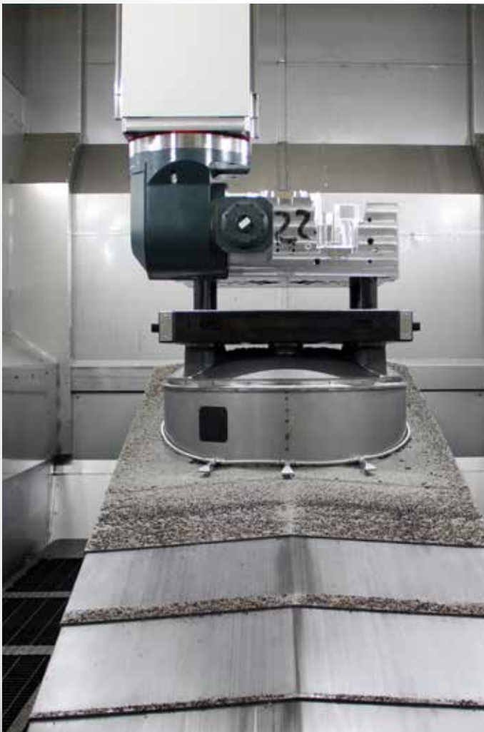
靈活性：傾斜的工作台允許使用五軸在五個表面上鑽孔與銑削。
