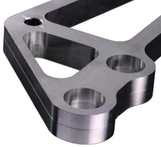
第二次加工之後清晰可見： 這是因為滾珠螺桿的熱膨脹， 導致了70 μm的偏差
