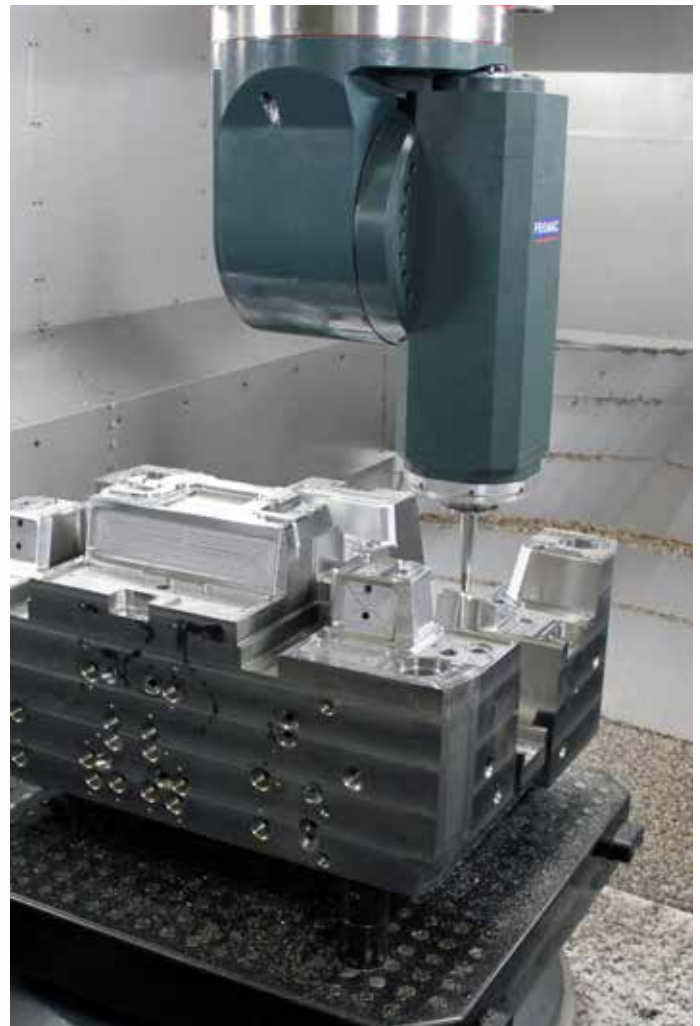
可調整性：機台刀頭更換系統可在同一機台上進行所有類型的加工。
