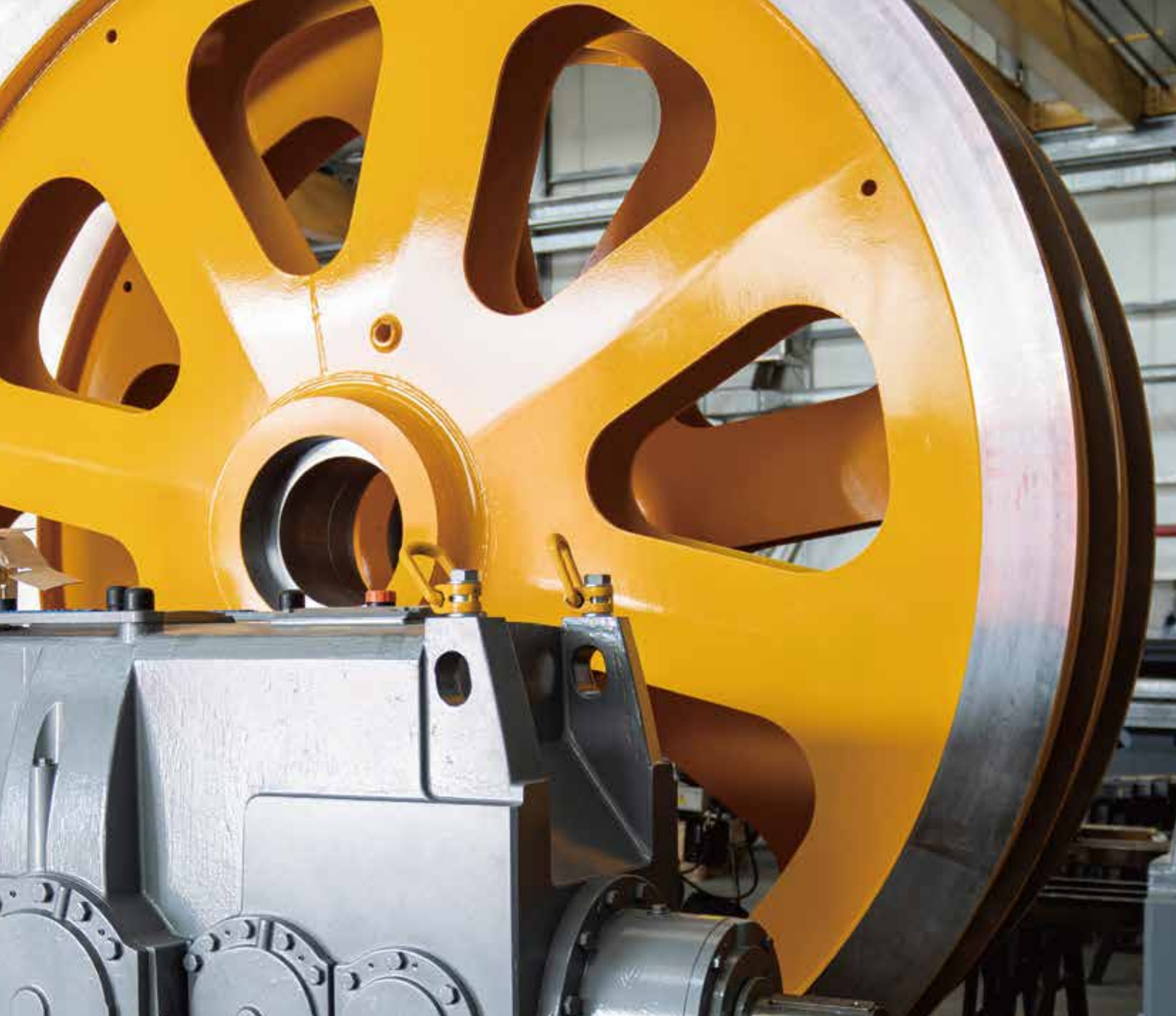
令人印象深刻的機台尺寸：用於倫敦盧頓機場的每個直徑3.6米纜繩滑輪及其驅動系統。
