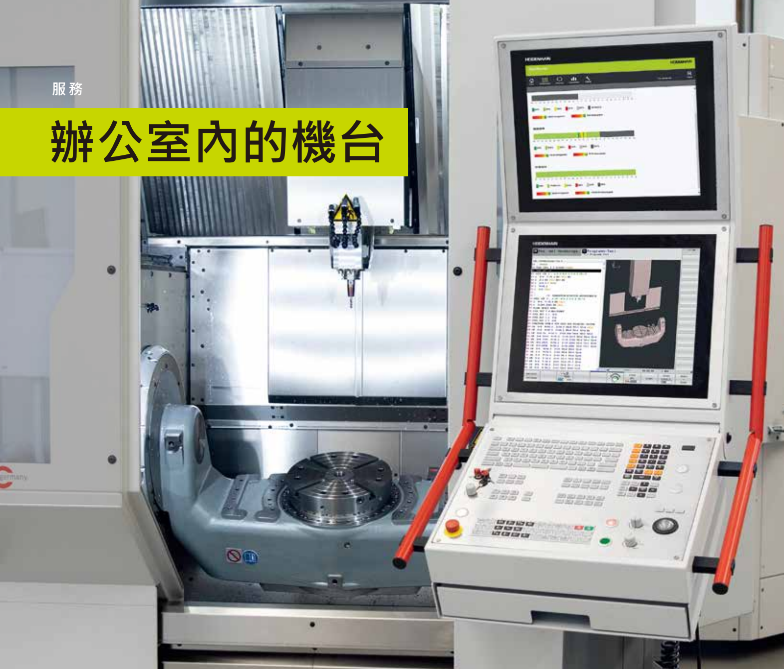
工廠內的原版：搭配TNC 640的5軸加工中心機。
