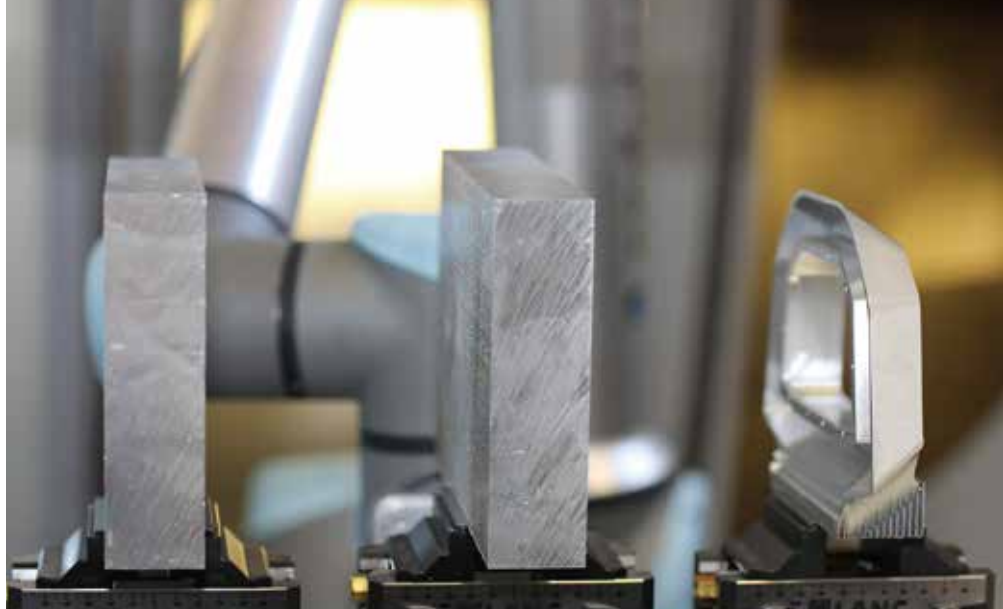
準備夜班：工作台更換器中的工件毛坯。
