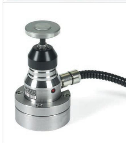
旋轉式或靜態的刀具會偏移了 TT 的接觸板；利用一整合式光學開關，一觸發信號會產生，並傳送到 CNC，進行刀具磨耗的補正。
