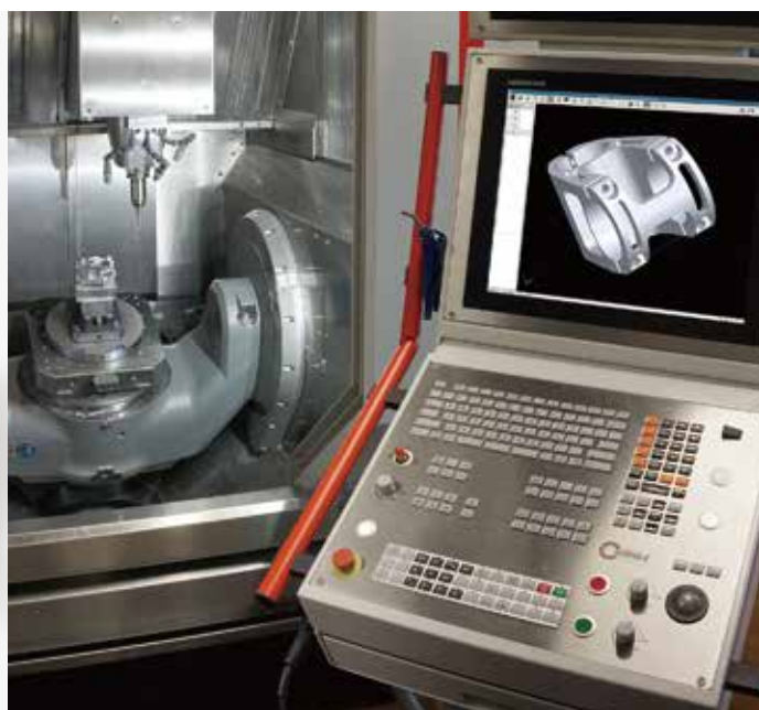
複雜組件的3D資料，例如這種登山自行車手把安裝座，可直接載入至NC程式中。
