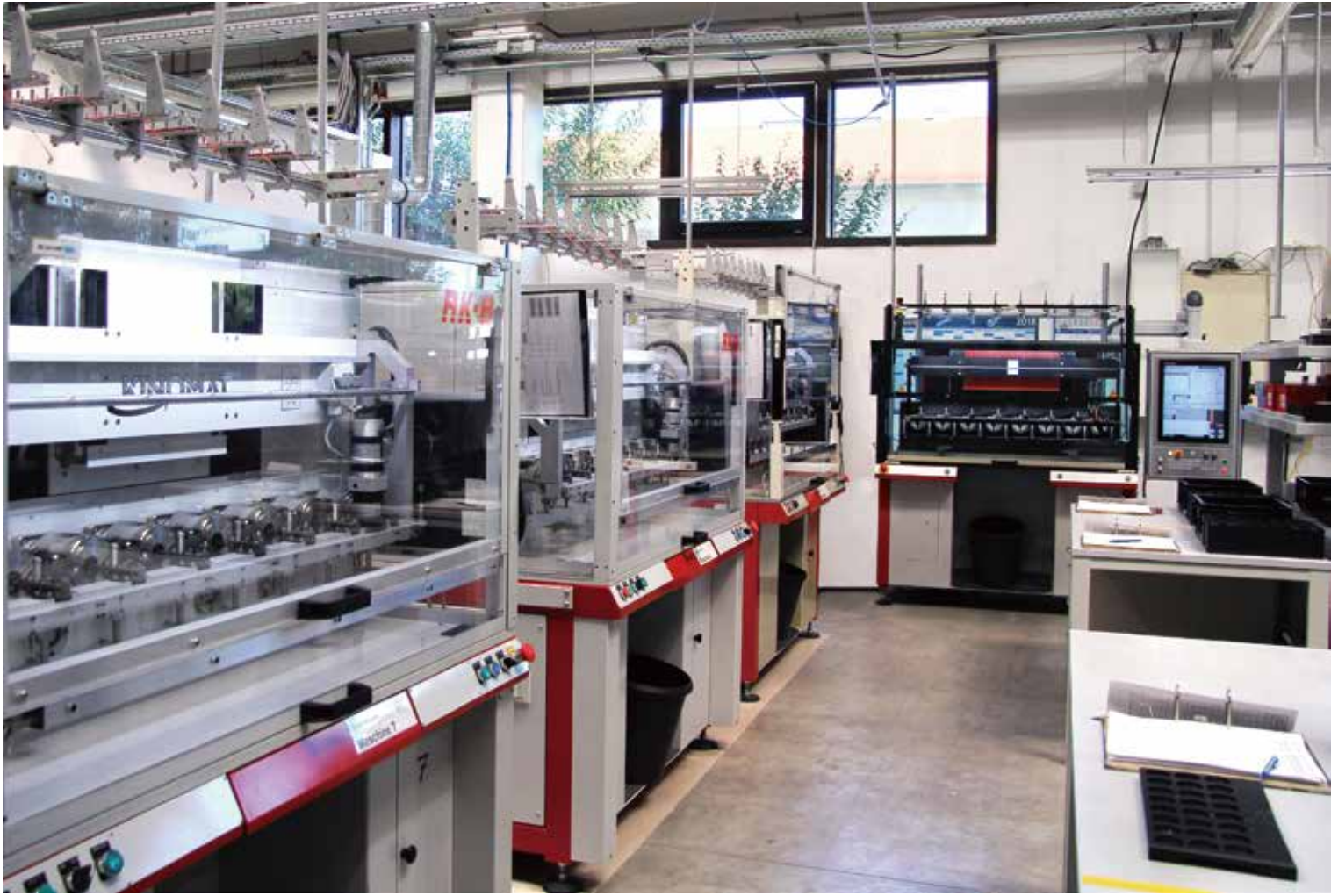
配備TNC 620控制器升級後的解角器繞線機位於後端，左側六個系統中的三個系統將在2019年底進行改裝。
